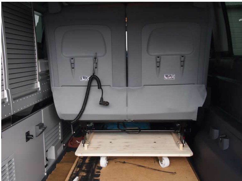
Abbildung 7: Sitzbank auf Hilfsvorrichtung
