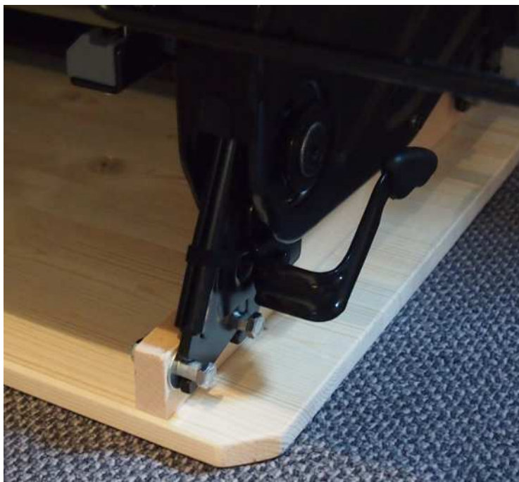
Abbildung 6: Vorderer Sitzbankfuß in Hilfseinrichtung verriegelt
