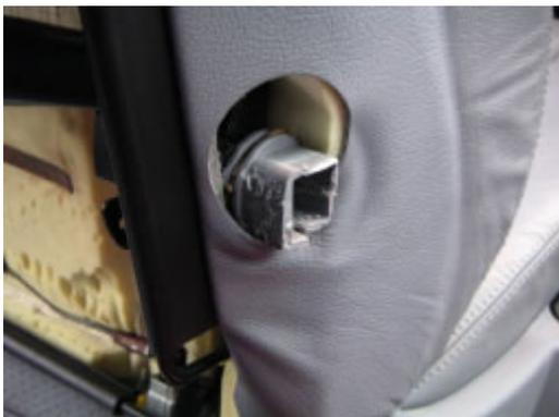
Ist der Haltering weg, kann man die Rückwand anheben und nach hinten klappen.
