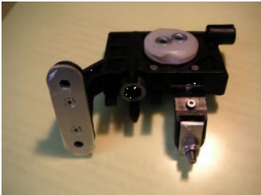
Beim Wiedereinbau ist darauf zu achten, dass man den Bowdenzug wieder einhängt, bevor man das Getriebe montiert. Das Getriebe selbst kann man mit M4-Schrauben und –Muttern befestigen. Die Funktion nochmals mit dem Handrad testen, bevor man Rückwand und Armlehne wieder befestigt (alles in umgekehrter Reihenfolge).
