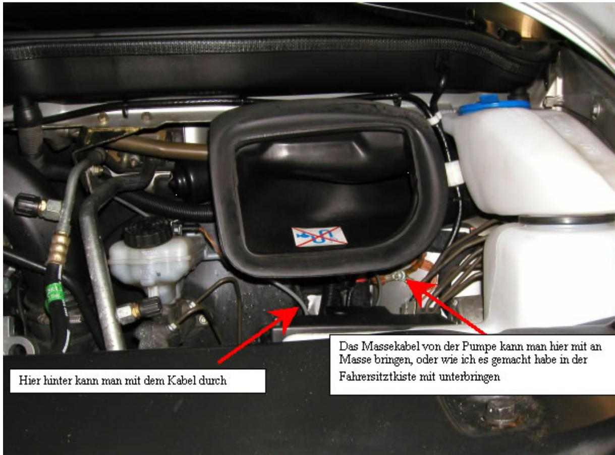
Hier hinter kann man mit dem Kabel durch
