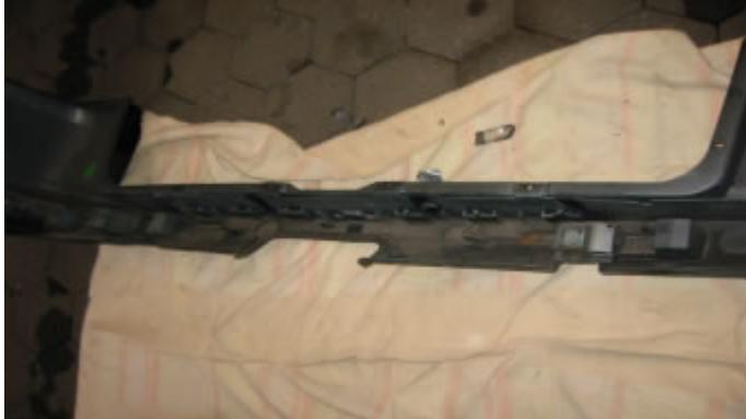
Montiert man einen neuen Stoßfänger müssen die Ausschnitte für AHK selbst eingesägt werden, also den "alten" als Schablone behalten.
