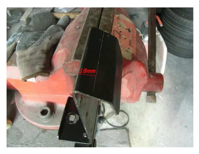
Nun geht es an das Durchtrennen des Halters, die vorhandenen Löcher benötigt man später zum zusammenfügen mittels zwei M6 Flachkopfschrauben.
