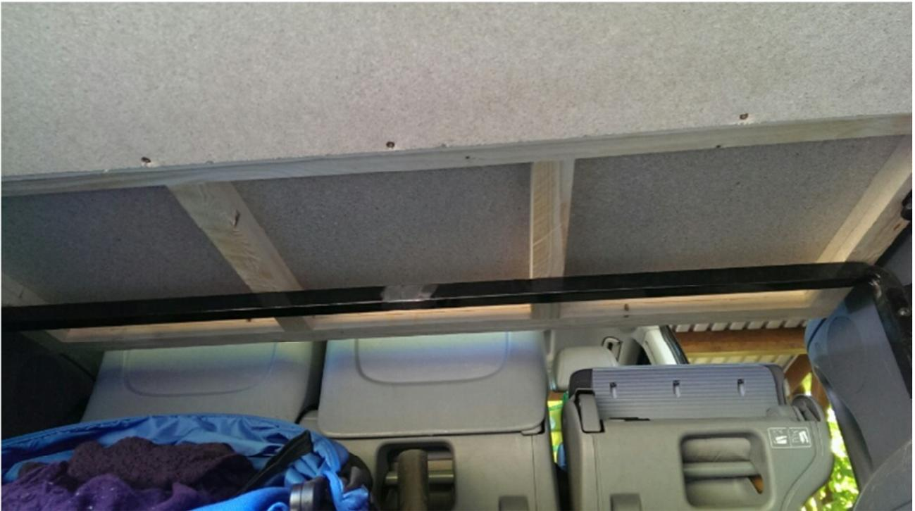
Verbunden mit den Scharnieren wird das ganze über M8x70 Schloßschrauben. Zum Befestigen habe ich M8 Hutmuttern verwendet, so ist das ganze ohne Werkzeug demontierbar.
