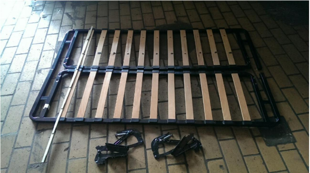
Nachdem das Bett in seine Einzelteile zerlegt ist, werden die Scharniere links und rechts durch die Seitenverkleidung an einer dort befindlichen Metallstrebe angeschraubt.
