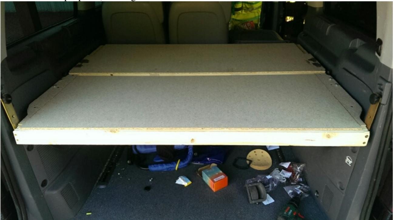
Die Befestigung der Ablage erfolgt über Metallwinkel an den original Aufhängepunkten der Kofferraumabdeckung. Gut zu sehen links und rechts. Nachdem der Rohbau steht, wird dieser geschliffen an den Kanten und anschließend mit Teppich bezogen. Wichtig hierbei ist, dass es ein Teppich ohne Kaschierung ist.
