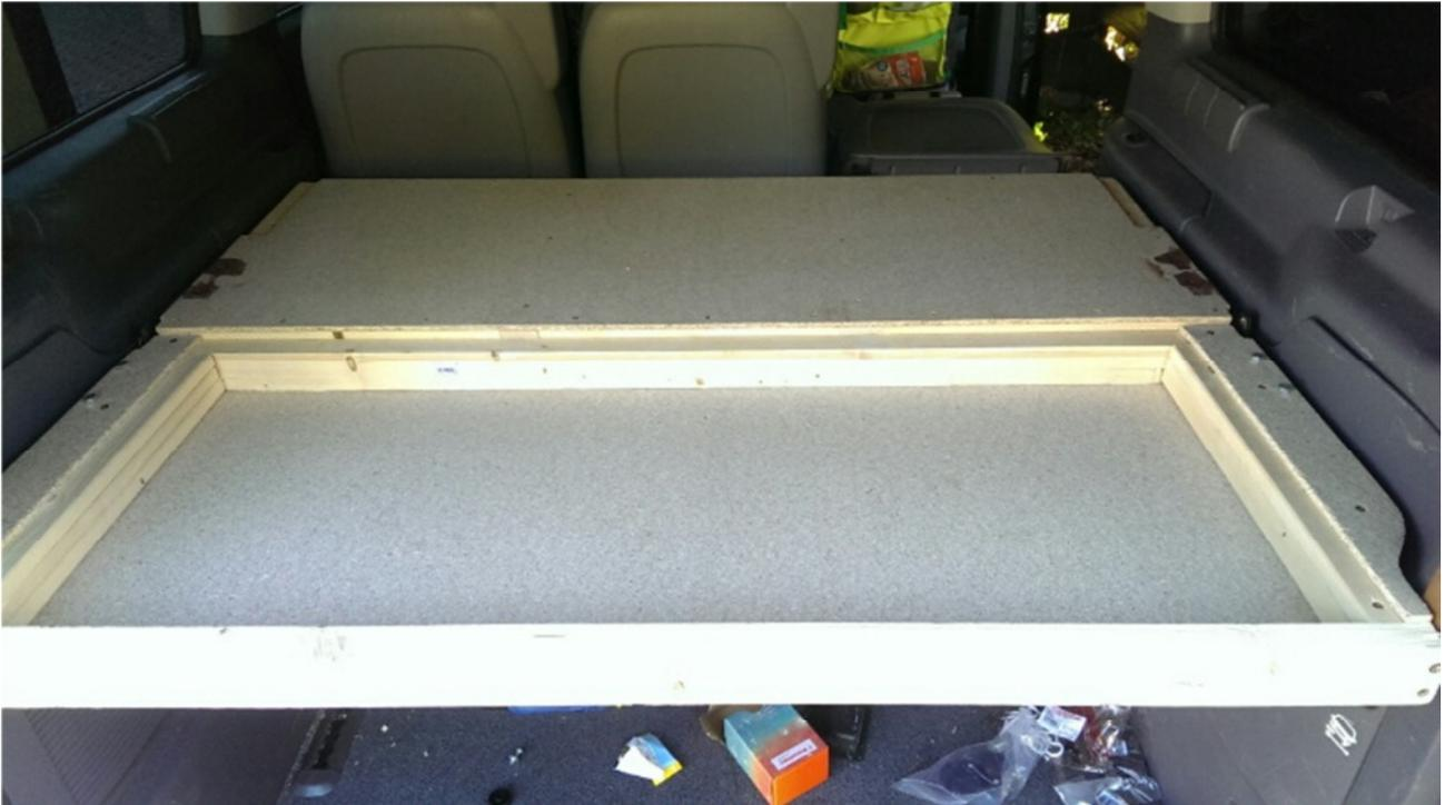
Gut zu sehen die Deckplatte der hinteren Ablage und das entstandene Staufach in der vorderen Ablage. Die Schloßschrauben habe ich oben bündig versenkt und mittels Kraftkleber mit der Deckplatte verklebt. (Zu sehen an den braunen Flecken an der hinteren Ablage. Der Deckel besteht auch aus einer Spanplatte, befestigt mittels Klavierscharnieren.
