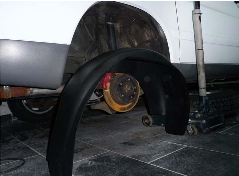
Jetzt hab ich den Innenkotflügel mit einer Hilfskonstruktion im Radhaus provisorisch fixiert. Behilflich waren: eine Dachlatte und ein Pickelstiel. Ein prima Gespann.
